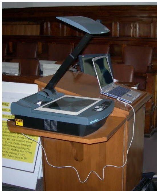
Der Professionelle Visualizer nimmt Bilder mit 3-CCD auf (das heißt lebensechte Farbe und hoher Kontrast) und kann eine entscheidende Rolle in den medizinischen Fällen des NYS Supreme Court haben. Hier ist der Visualizer an einen Laptop angeschlossen und nimmt ein Röntgenbild auf, welches auf den Bildschirmen des Richters, der Jury und der Rechtsanwälte zu sehen ist. So muss das Beweisstück nicht mehr herübergereicht werden, was viel Zeit spart.
