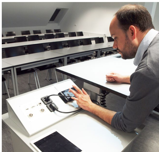
Über das Touchpanel kann der VZ-C6 Visualizer gesteuert werden.
